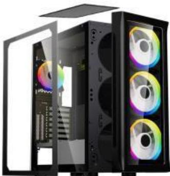
Por favor, retire los tornillos antes de desmontar el panel lateral.
