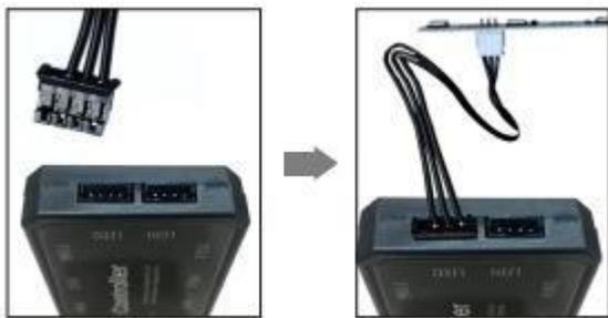
2. Conecte los ventiladores al HUB en los puertos marcados como FAN. Hay 10 puertos disponibles para conectar los ventiladores (por favor, mantenga el orden en el que utiliza los puertos del HUB)
